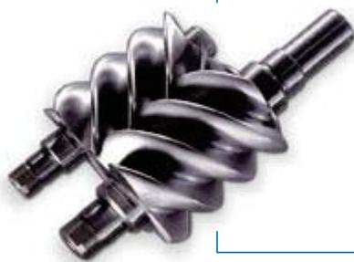
Les compresseurs rotatifs de la série MISTRAL sont équipés d'un bloc rotor à une étape pourvu de vis asymétriques montées sur roulements. Leur mise en marche est effectuée au moyen d'un moteur électrique triphasé asynchrone avec protection IP 55/F-B, à travers des courroies trapézoïdales. Ce système de transmission offre une grande fiabilité et faible niveau sonore.
