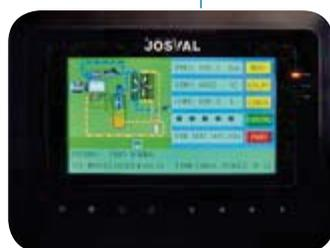
Le panneau de commandes, régi par la plaque électronique de contrôle, nous informe, à tout moment, de l'état dans lequel se trouve le compresseur (température de fonctionnement, heures de travail, intervalle de maintenance, pression existante, mode de fonctionnement. etc.) et permet sa mise en marche et son arrêt.
